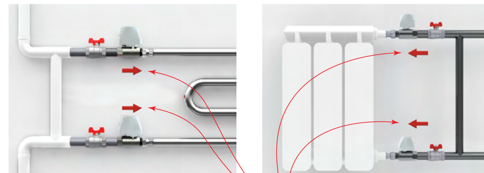
Монтаж на полотенцесушитель
